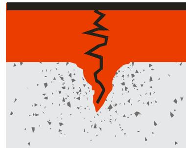
▶ 两、三年后，表面上大约有2 - 3mm已经氧化和硬化，但表面层下仍有15mm或以上 [沥再生]<sup>TM</sup> 保护层。
