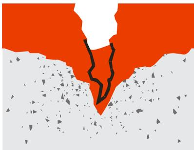
▶ 施用后 (虽仍可见到裂缝但已能够防止大部份水, 汽油及其它化学物质侵蚀)
