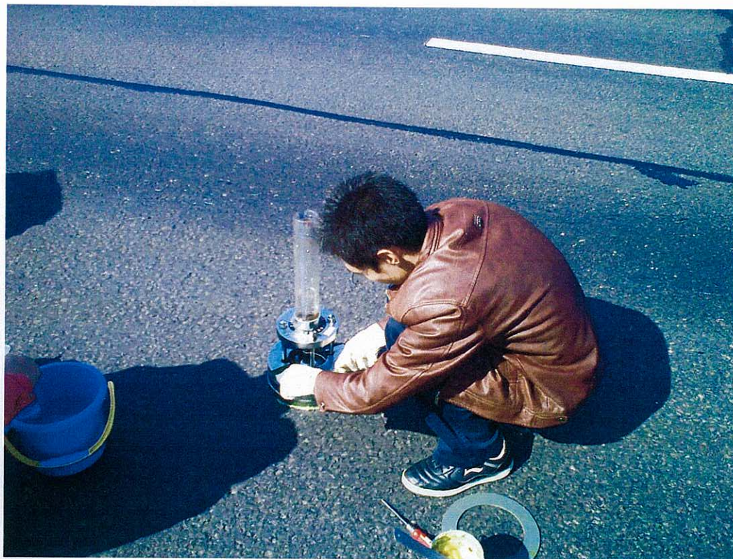
附图 1 路面渗水试验
