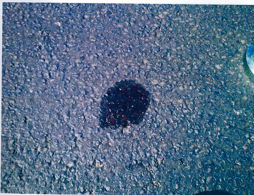
附图 4 汽油未渗入[沥再生]路面
