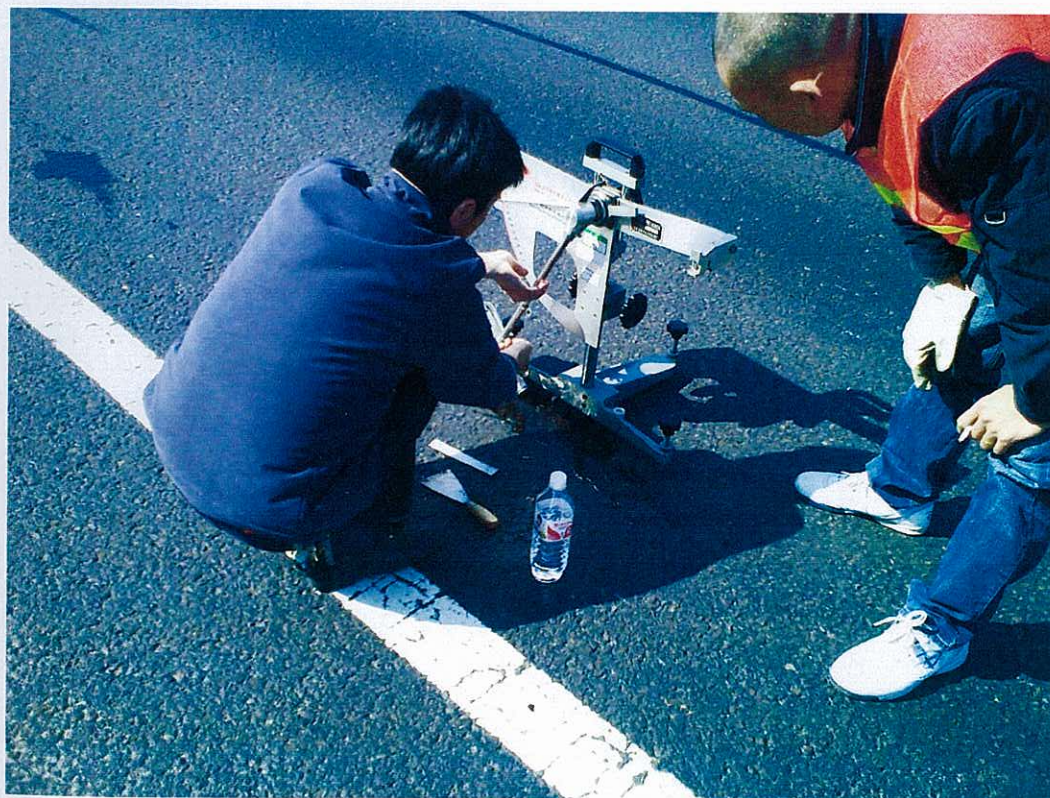
附图 2 路面抗滑性能测试
