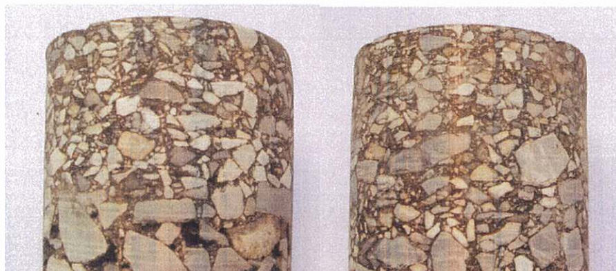
图 1 使用[沥再生]芯样（左）和未使用[沥再生]芯样（右）
