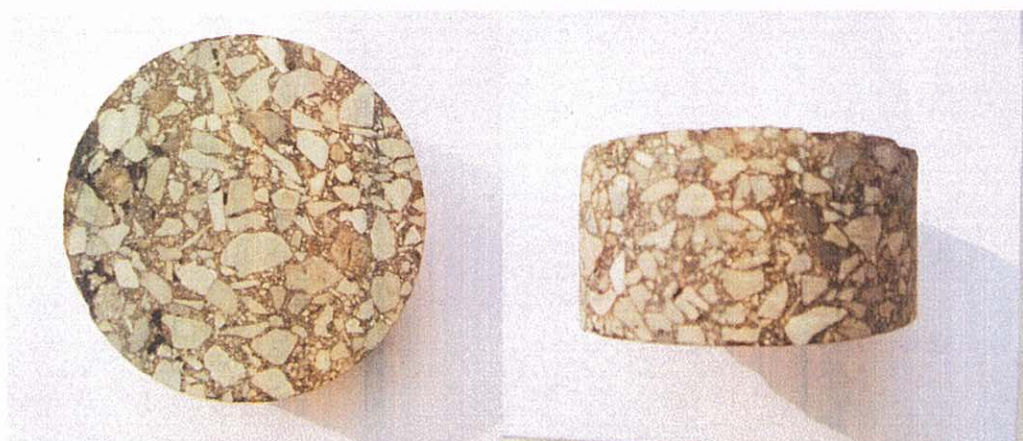
图2 未使用[沥再生]芯样切割后
